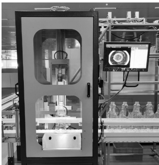
图 1 玻璃瓶缺陷检测系统及结构图
