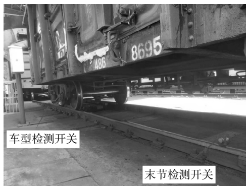
图 4 现场实际安装位置
