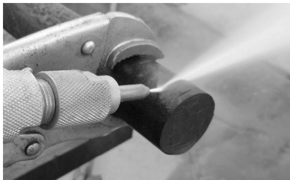
图2 高压水射流切割金属件
